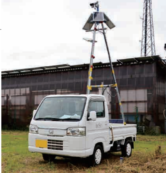
▲遠隔監視装置「モニター」
