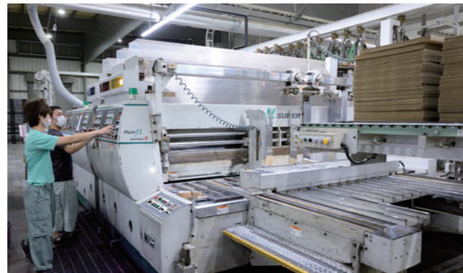
最新式の段ボール加工システム「F F G」。一つのラインで段ボールに印刷を施し、切り込みを入れて接着され、束ねたものが出てくる
