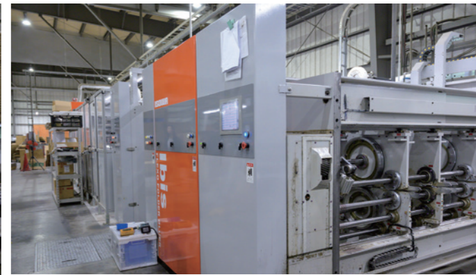
最新式の段ボール加工システム「F F G」。一つのラインで段ボールに印刷を施し、切り込みを入れて接着され、束ねたものが出てくる
