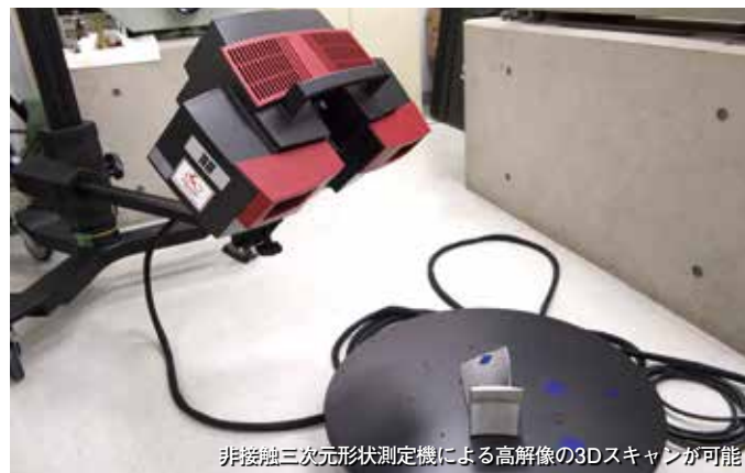
非接触三次元形状測定機による高解像の3Dスキャンが可能
