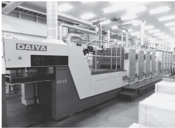
▲最新鋭の印刷機「三菱重工製タンDEM8色機（4色両面）New DAIYA308TP UV」
